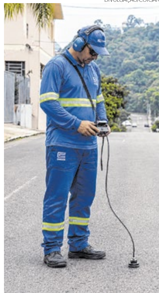
Corsan também usa geofones para identificar vazamentos
